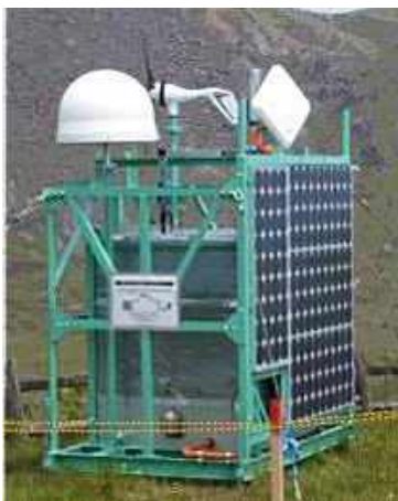
Рис. 9. REGMOS / (Станція дистанційної системи моніторингу GNSS)
