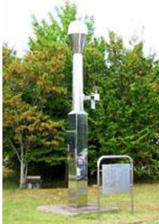
Рис. 7. Безперервно працююча опорна станція (CORS)
